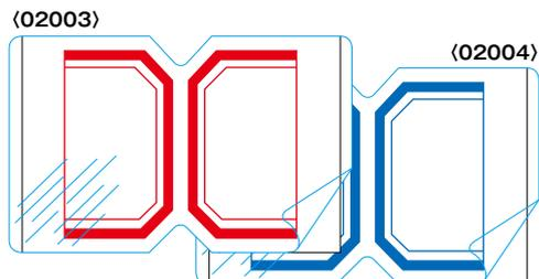
ラベル寸法:26mm × 38mm、フィルム寸法:26mm × 41mm
