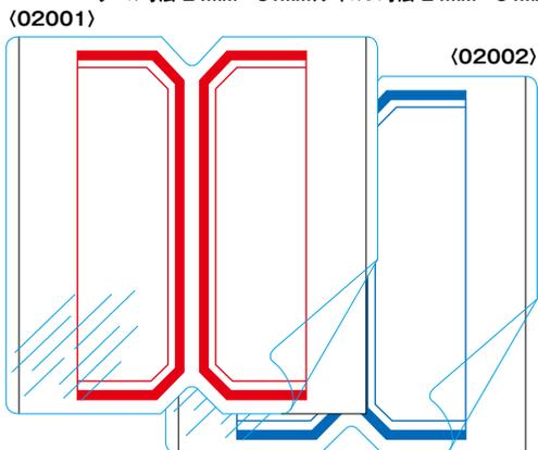
ラベル寸法:46mm × 42mm、フィルム寸法:46mm × 45mm
