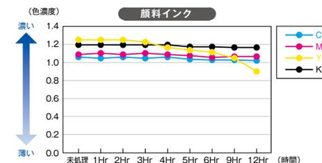
色相濃度測定機器：グレッタマグベスRD918 4Hr=1ヵ月、12Hr=3ヵ月の換算です。エーワン調べ(エーワン製マット紙ラベルに「普通紙 きれい」で印刷した結果です。)
